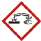
Danger de corrosion
